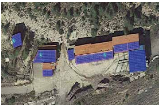
Projecció d'instal·lació fotovoltaica sobre cobertes d'edificis
