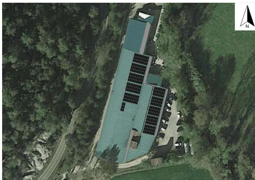
Figura 44. Fotomuntatge instal·lació 99,63 kWp
