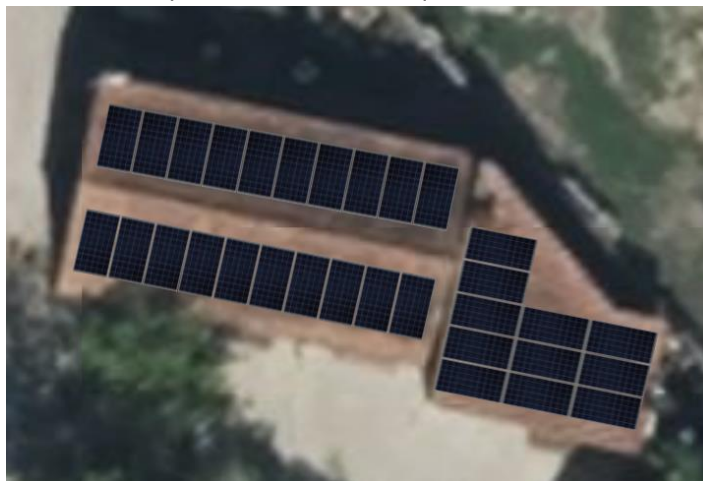
Figura 23. Fotomuntatge instal·lació Fase II Font: OpenSolar
