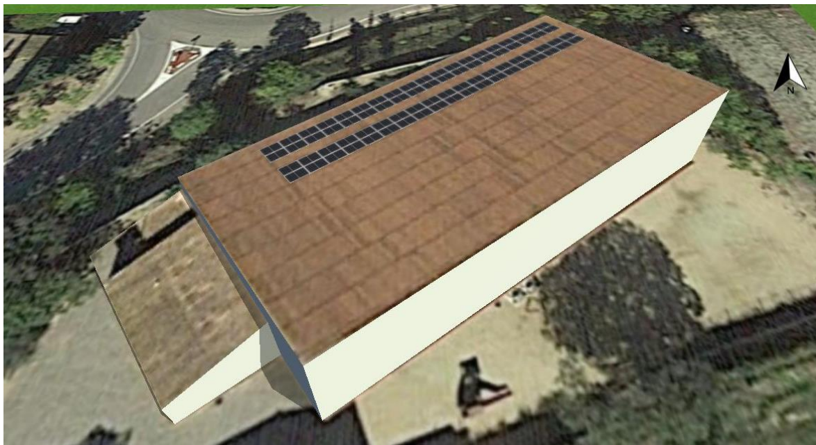
Figura 4. Imatge en 3D de la instal·lació FV plantejada 1. Font: PVSOL.
