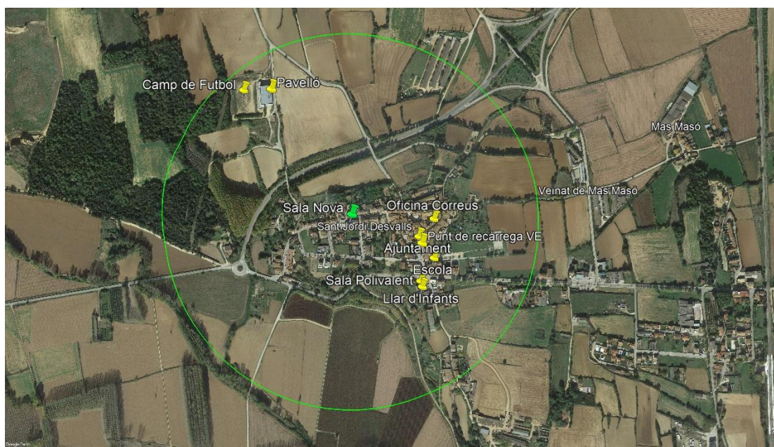
Figura 10. Equipaments associats i radi d'actuació Instal·lació FV 1 amb el punt de recàrrega de VE. Font: elaboració pròpia i Google Earth.
