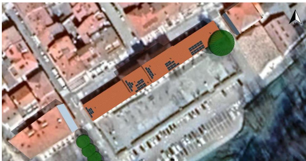
Figura 7. Imatge en 3D de la instal·lació FV plantejada 2. Font: PVSOL.
