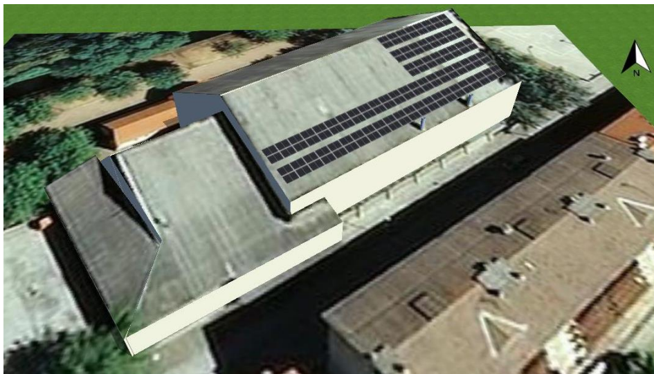
Figura 4. Imatge en 3D de la instal·lació FV plantejada 1. Font: PVSOL.
