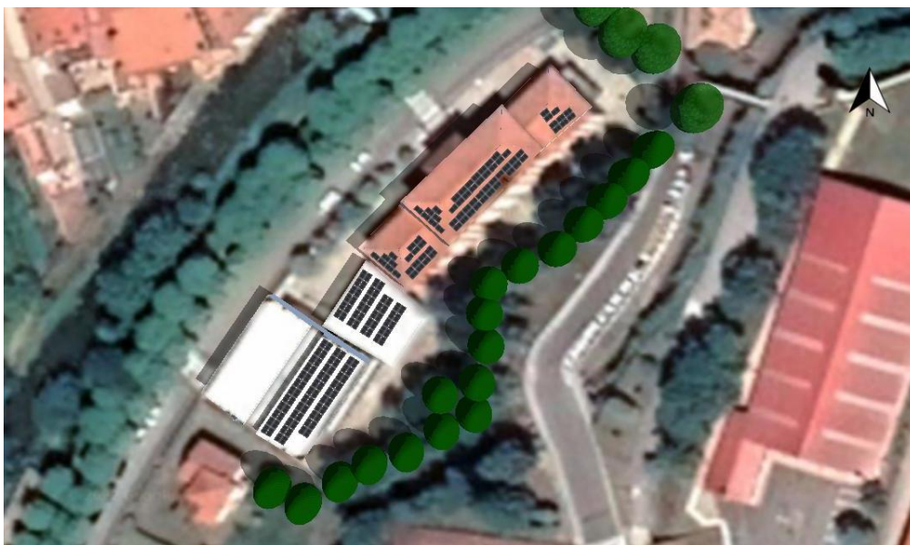
Figura 9. Imatge en 3D de la instal·lació FV plantejada 3. Font: PVSOL.
