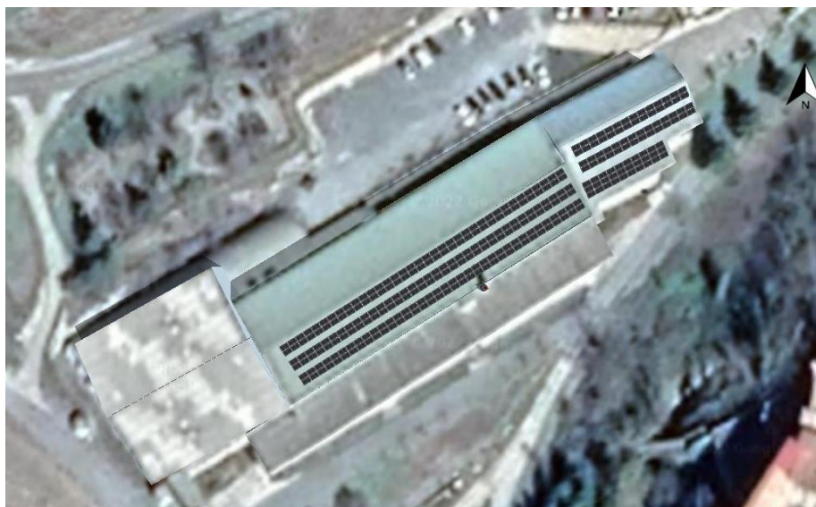
Figura 7. Imatge en 3D de la instal·lació FV plantejada 2. Font: PVSOL.
