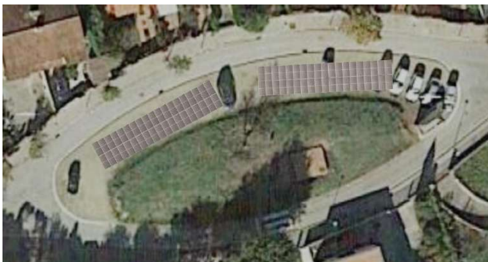
Imatge 11. Proposta d'instal·lació de panells cobrir amb pèrgoles l'aparcament.
