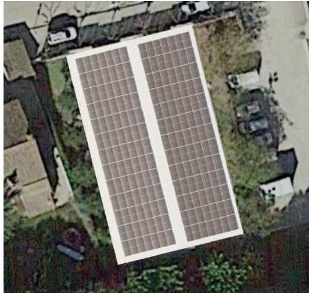
Imatge 12. Proposta d'instal·lació de panells si es cobreix la pista esportiva.
