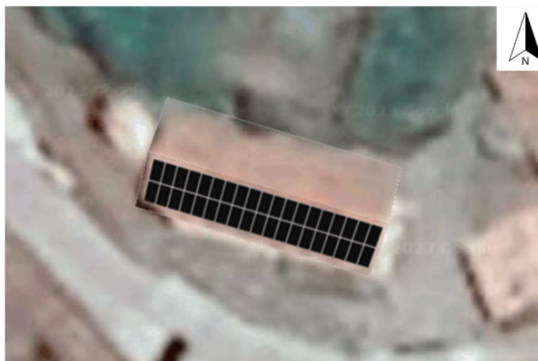
Figura 26. Fotomuntatge instal·lació Fase II Font: SolarEdge Designer
