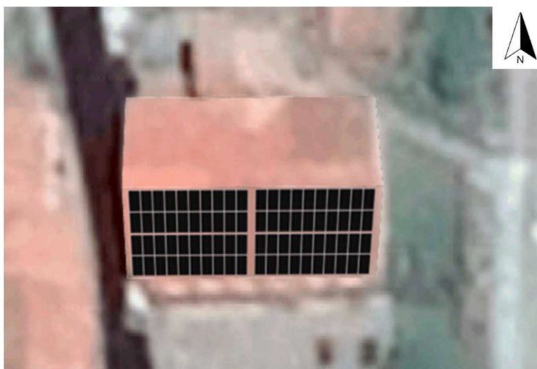
Figura 29. Fotomuntatge instal·lació Fase III Font: SolarEdge Designer
