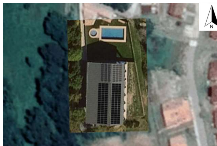
Figura 23. Fotomuntatge instal·lació Fase I Font: SolarEdge Designer
