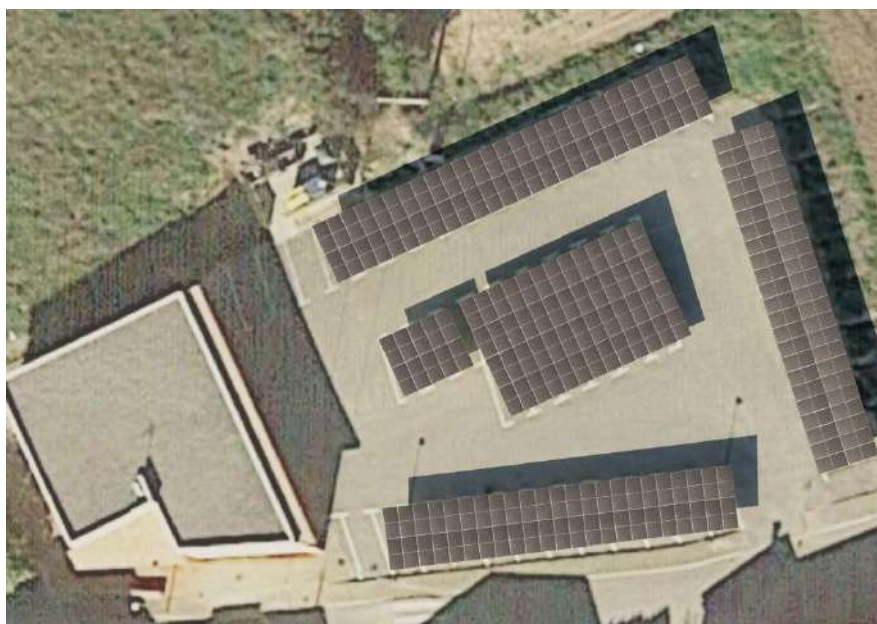
Imatge 16. Proposta d'instal·lació de panells si es cobrí l'aparcament de la Sala Tramuntana.
