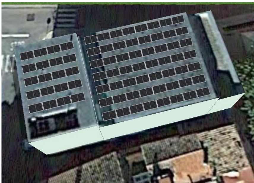
Figura 4. Imatge en 3D de la instal·lació FV plantejada 1. Font: PVSOL.
