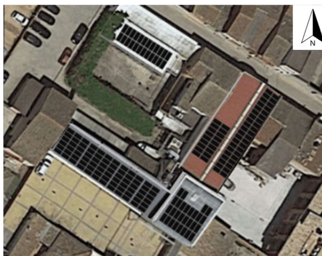
Figura 36. Fotomuntatge instal·lació Proposta 2 Font: SolarEdge Designer
