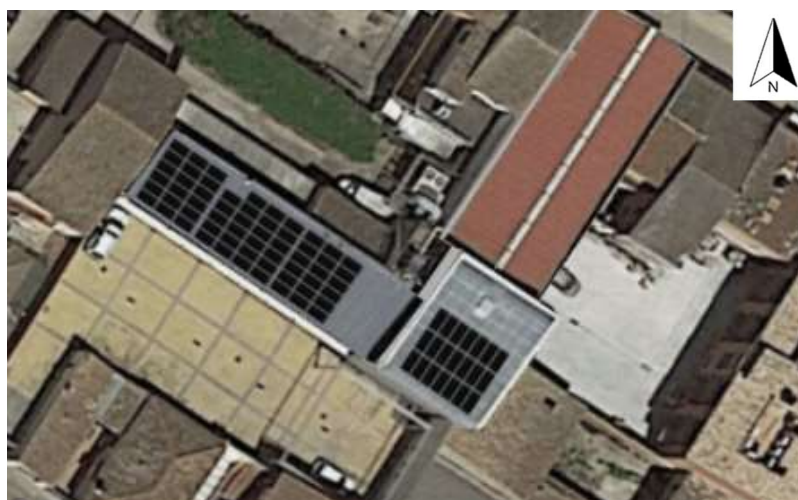
Figura 33. Fotomuntatge instal·lació Proposta 1 Font: SolarEdge Designer
