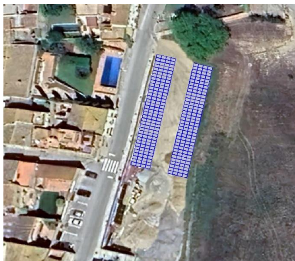
Figura 14. Croquis de la instal·lació fotovoltaica.
