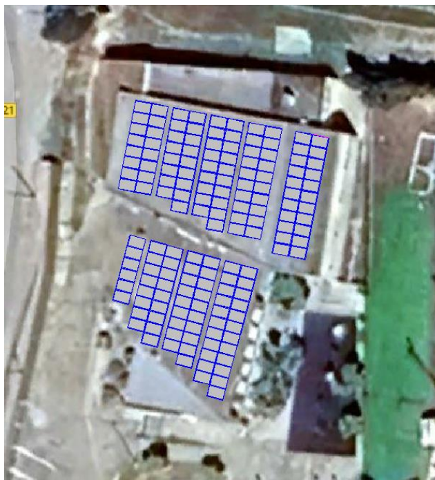
Figura 4. Croquis de la instal·lació fotovoltaica.
