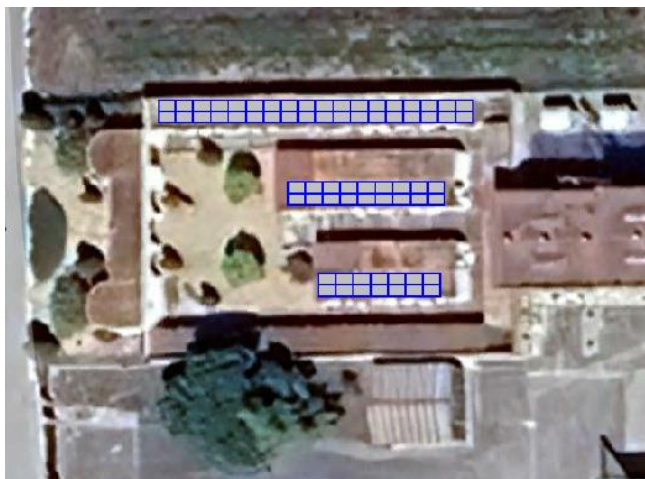
Figura 10. Croquis de la instal·lació fotovoltaica.
