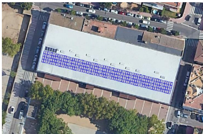
Figura 10. Croquis de la instal·lació fotovoltaica.
