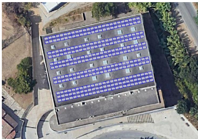
Figura 14. Croquis de la instal·lació fotovoltaica.
