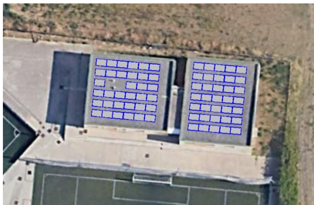
Figura 16. Croquis de la instal·lació fotovoltaica.
