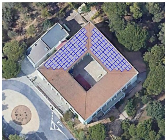
Figura 26. Croquis de la instal·lació fotovoltaica.
