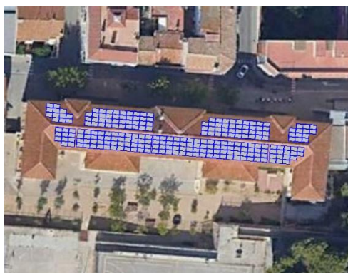
Figura 20. Croquis de la instal·lació fotovoltaica.
