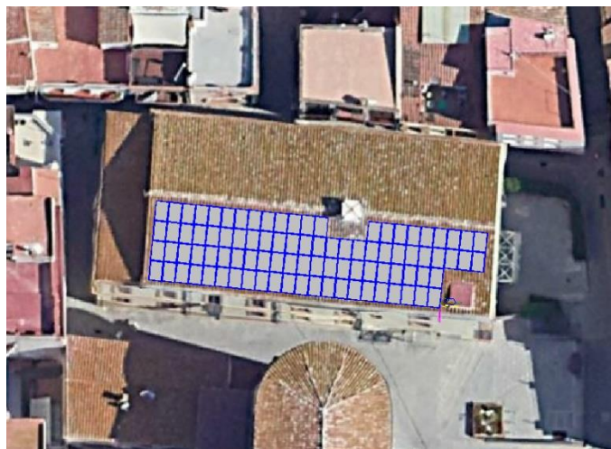
Figura 4. Croquis de la instal·lació fotovoltaica.
