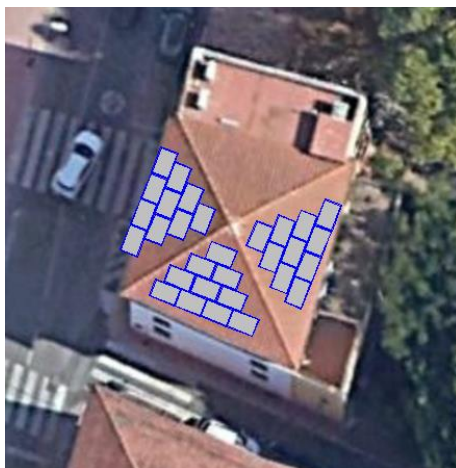
Figura 32. Croquis de la instal·lació fotovoltaica.
