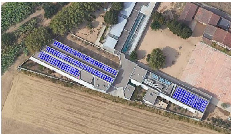
Figura 22. Croquis de la instal·lació fotovoltaica.
