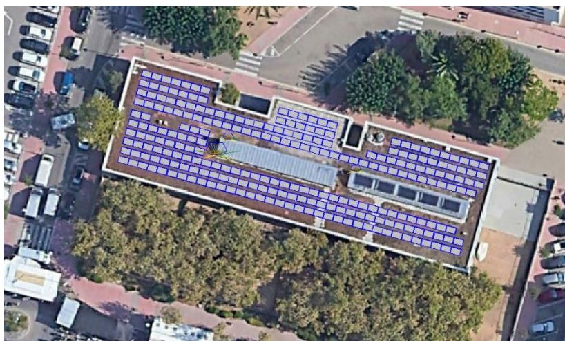
Figura 12. Croquis de la instal·lació fotovoltaica.
