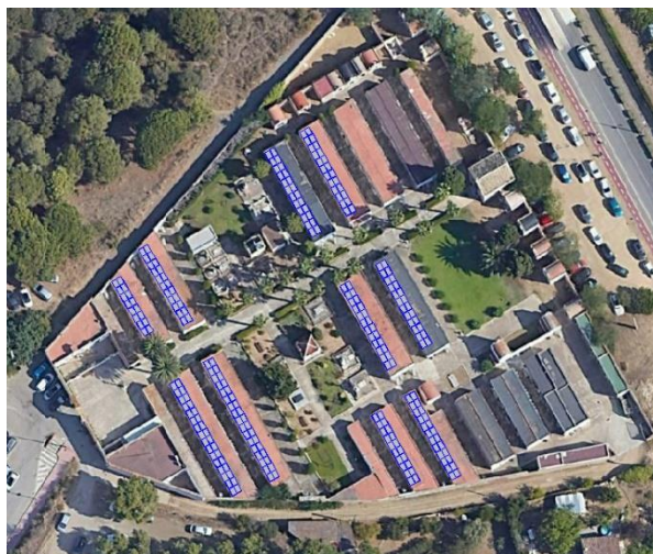
Figura 28. Croquis de la instal·lació fotovoltaica.
