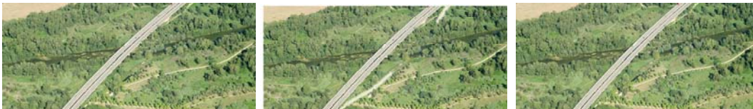
Foto 6 – Fotomuntatge il·lustratiu de l'impacte transitori del soterrament de la línia MAT. Abans, immediatament després de les obres i passat dos anys. Font: Elaboració pròpia.
