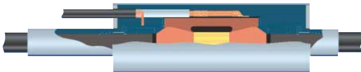
4 Esta junta prefabricada de cable EHV, desarrollada por ABB, no contiene materiales gaseosos ni líquidos y no precisa mantenimiento.
